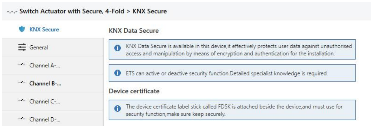
图 4.1 (1) “KNX Secure” 参数界面
